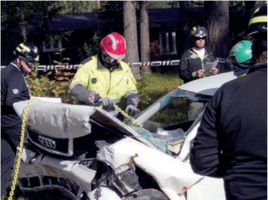
**Bild 7** Anschlagen der Ketten an den A-Säulen
