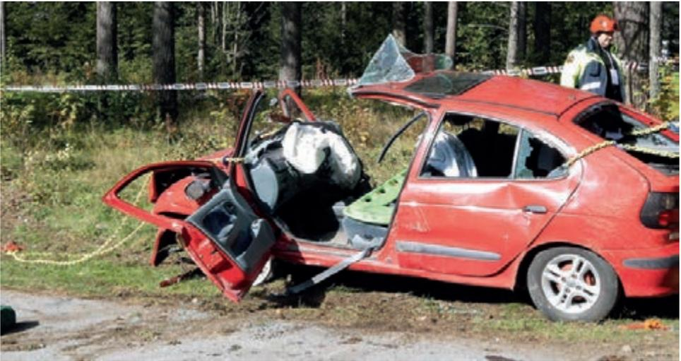
**Bild 15** Befreiungsöffnung nach erfolgter Rettung
