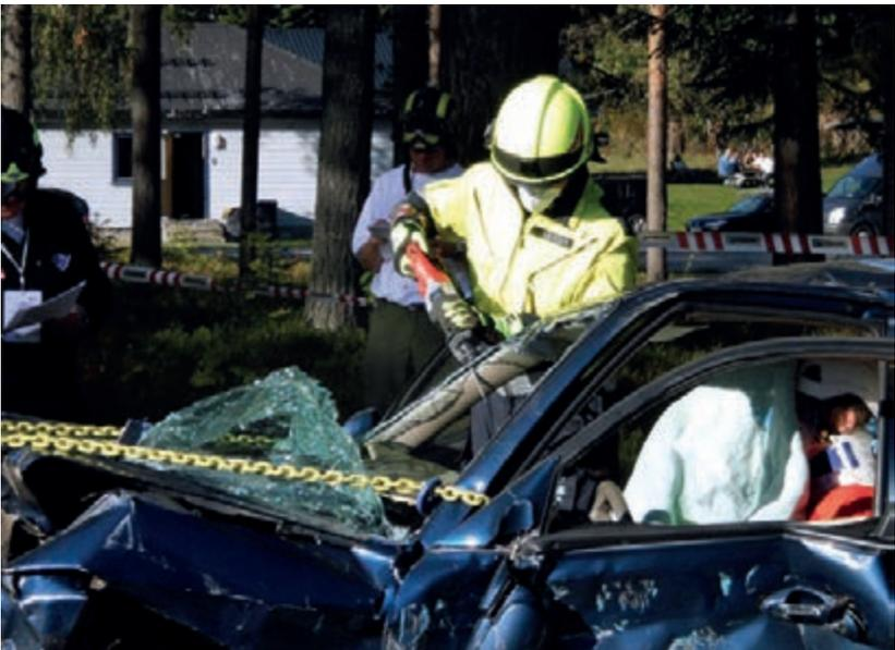
**Bild 10** *Durchtrennen der A-Säulen mittels Säbelsäge*
