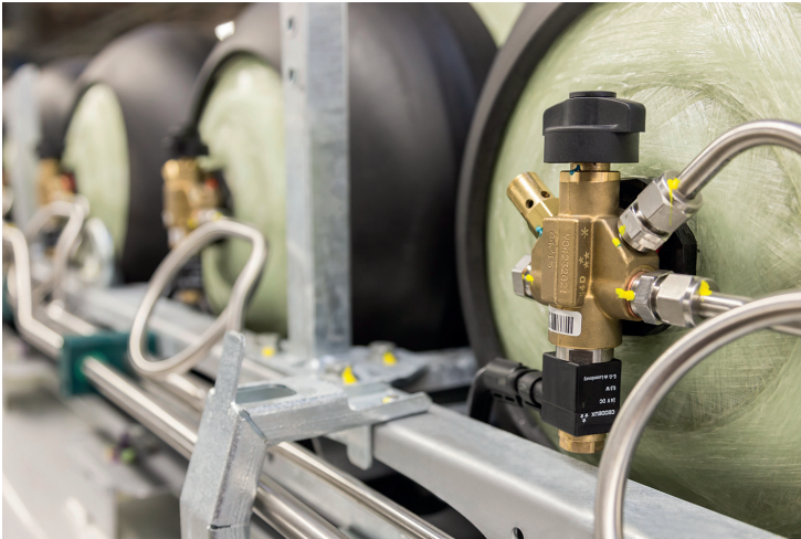
Bild 4 Beispiel für ein Flaschenventil an einem Erdgastank, hier auf dem Dach eines Buses. Oben auf dem Ventil befindet sich das mechanische Absperrventil, unten das elektromagnetische Absperrventil. In diesem Fall ist die Thermo­sicherung nach links oben gerichtet. (Foto: Daimler AG)
