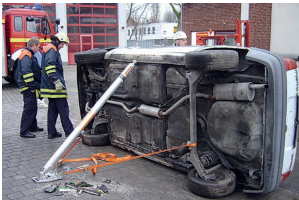
Bild 2: Stabilisierung mit einem Stützensystem (Foto: Jan Südmersen)
